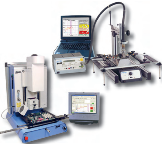
Fot. 5. PACE TF-1700 i PACE ST-325, urządzenia do prac z elementami SMD/BGA
