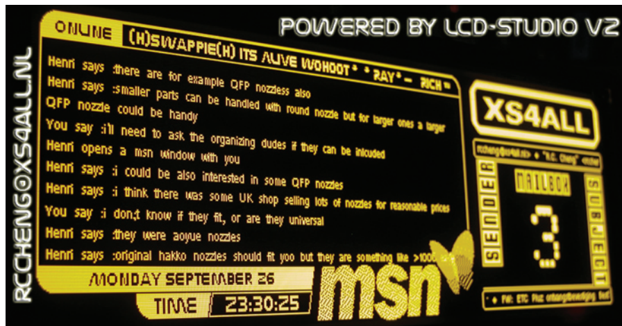
Fot. 1. Możliwości graficzne wyświetlaczy TFEL na przykładzie wyświetlacza Planar - EL640.200 SK ALE
