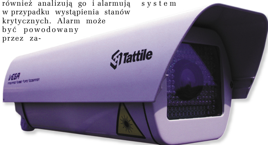
Fot. 1. Automatyczny czytnik tablic rejestracyjnych Vega
