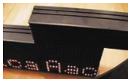
Fot. 2. Opatentowany system łączenia pojedynczych modułów w większe ekrany
