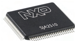
Fot. 3. Mikrokontroler SJA2510 wyposażono w szybki rdzeń ARM968E-S i (między innymi) 2-kanalowy interfejs FlexRay
