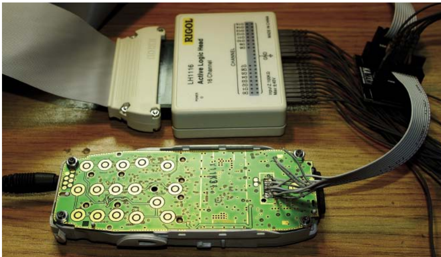
Fot. 10. Zestaw do odczytywania komend wysyłanych do sterownika wyświetlacza
