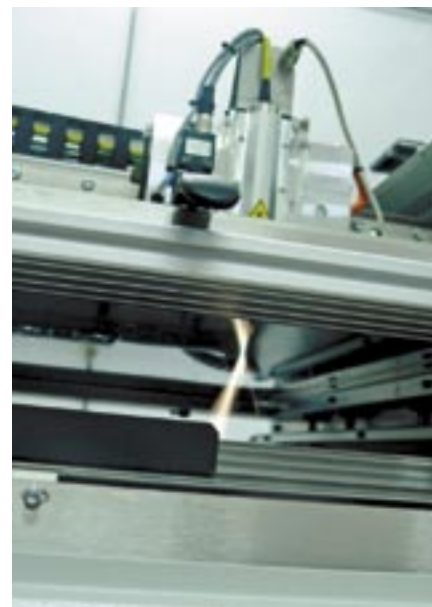
Fot. 5. Wycinanie otworów laserem w maszynie G6060
