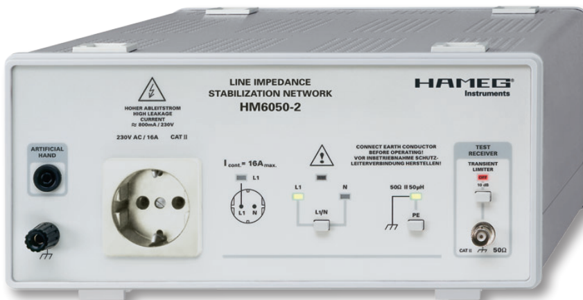
Fot. 1. Sieć sztuczna (LISN), taka jak HAMEG HM6050-2, jest używana do odizolowania, identyfikacji i pomiaru zaburzeń przewodzonych
