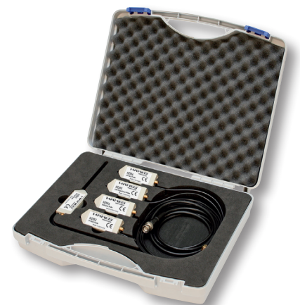
Fot. 2. Zestaw aktywnych sond HZ540/550, które mogą być używane do pomiaru natężenia pola magnetycznego. Jego natężenie jest proporcjonalne do wartości prądu płynącego w obwodzie
