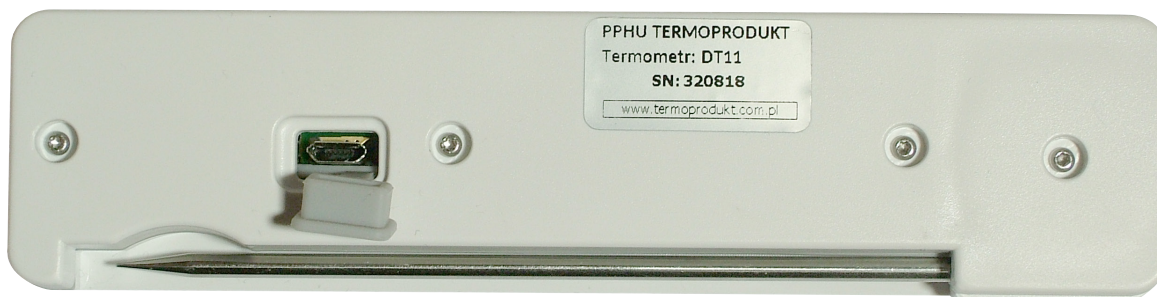
Fotografia 2. Termometr z sondą umieszczoną w komorze transportowej
