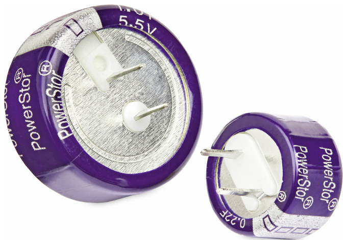
Fotografia 5. Superkondensatory. Mniejszy z przedstawionych jest w stanie zgromadzić energię 0,99 J przy napięciu 3 V, 2,75 J przy napięciu 5 V i 3,33 J przy napięciu znamionowym (5,5 V). Nawet jeśli wykorzystywać tylko energię pełnego kondensatora, ale przy założeniu że napięcie na nim nie może być niższe niż 3 V, wystarczyłaby ona na 22330 cykli pomiarów w przedstawionym przykładzie, a więc na 15 dni pracy (bez zewnętrznego źródła energii) z przesyłaniem wyników co 1 minutę
