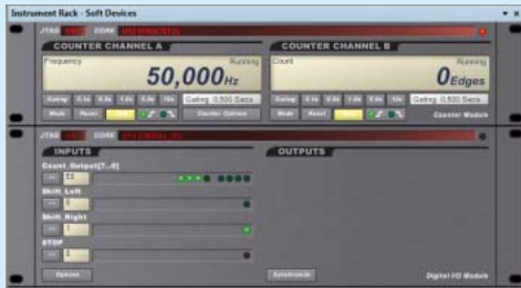
Rysunek 10. Widok panelu miernika częstotliwości, panelu cyfrowych wejść/wyjść przed konfiguracją
