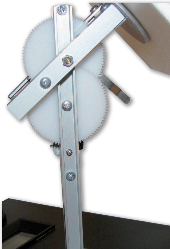
Fotografia 6. Listwa zasłaniająca transoptor szczelinowy informujący o osiągnięciu pozycji, od której jest odmierzany kąt nachylenia
