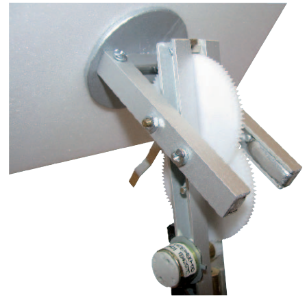
Fotografia 3. Widok silnika napędzającego mechanizm pozycjonujący panel w pionie
