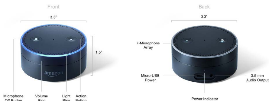
Rysunek 1. Głośnik Echo Dot. Budowa i parametry
