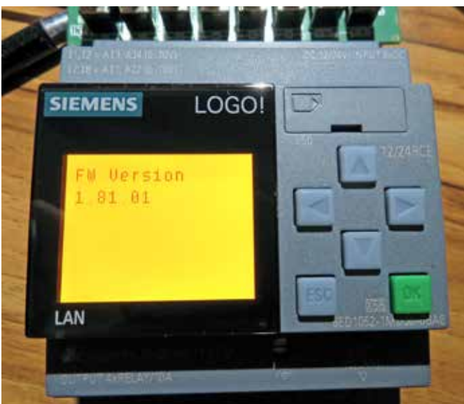
Fotografia 5. Alternatywnym sposobem identyfikacji wersji sterownika jest sprawdzenie wersji firmware
