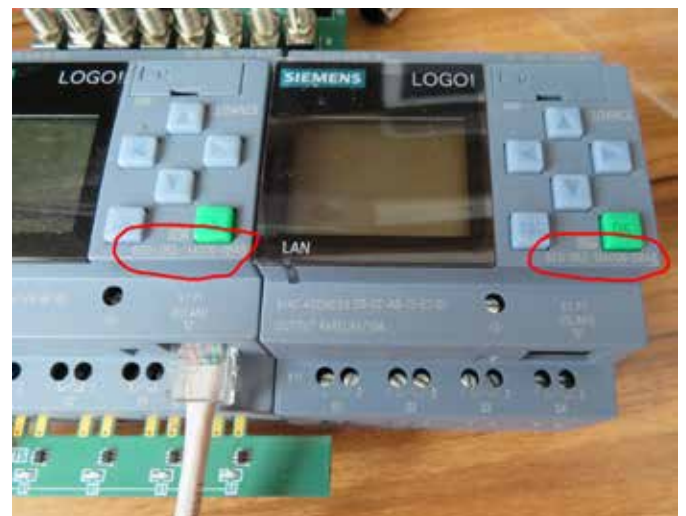
Fotografia 2. Numery katalogowe na obudowach LOGO! 8 (z lewej) i LOGO! 8.FS4 (z prawej) są także identyczne
