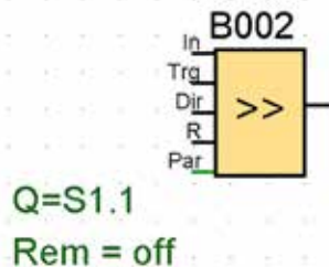
Rysunek 10. Modyfikacje objęty także symbol rejestru przesuwne-go, który wyposażono w wejście zerujące
