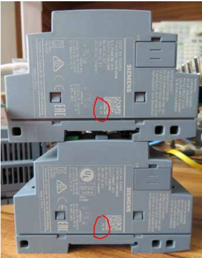
Fotografia 4. Oznaczenie wersji FS sterowników LOGO! wygrawerowano na bocznych ściankach obudów
