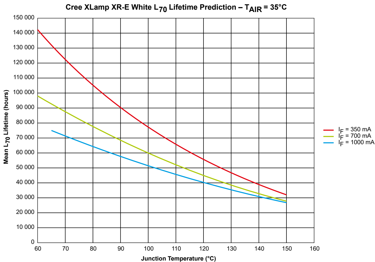
Rysunek 2. Szacunkowa żywotność diody LED zależnie od temperatury złącza i prądu przewodzenia
